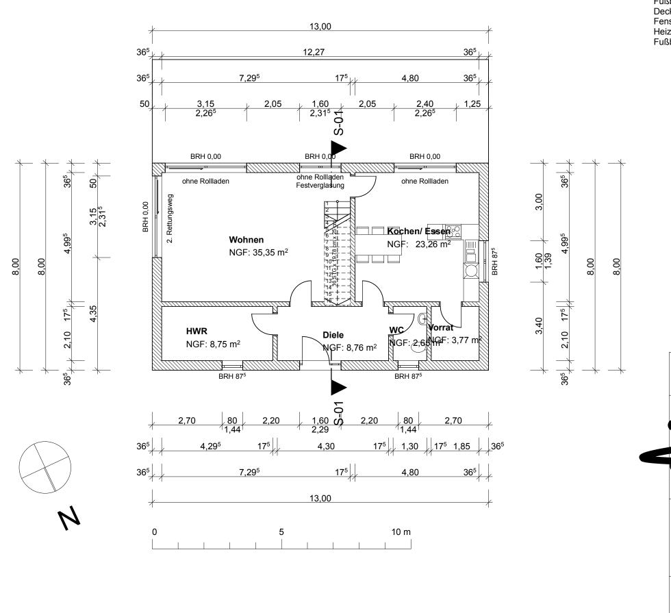
Gründung auf tragfähigem Baugrund, frostsicher Bodenplatte mit Frostschürze und unterseitiger Dämmung lichte Raumhöhe EG 2,80 m Fußboden EG: 0,20 m Decke über EG: Stahlbetondecke ichte Raumhöhe OG: 2,60 m Fußboden OG: 0,15 m Decke über OG: Holzbalkendecke Fenster in Kunststoff 3-fach Verglasung mit Rollläden Heizung Brennwertgerät + solar Fußbodenheizung mit raumweiser Regelung
